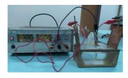
Рис. 14. Установка для получения патины электрохимическим путем
