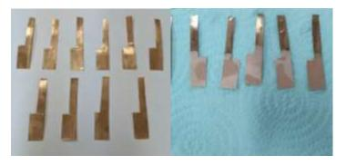
Рис. 4. Медные пластинки после протравливания
