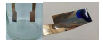
Рис. 9. Пластинки над раствором карбоната аммония (слева-влажная, справа – сухая)
